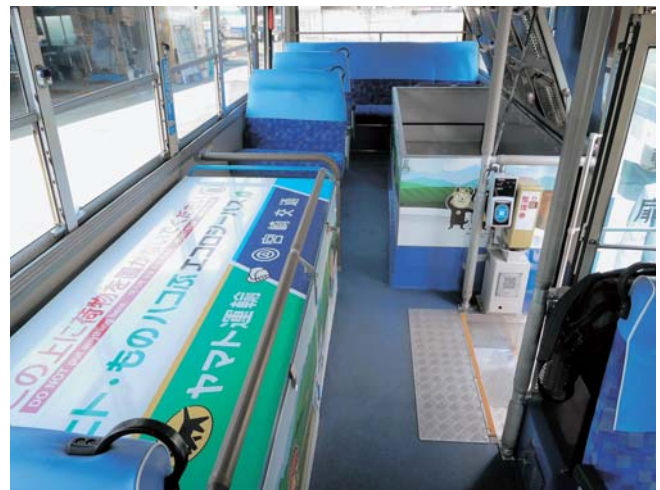
客貨混載用に改装されたバスの内部。荷物を積むスペースは2箇所に分かれており、写真下側（バスの前方側）は普通の荷物、上側はクール使用。クール使用には保冷剤がセットでき、また温度を記録する装置も備えている。
