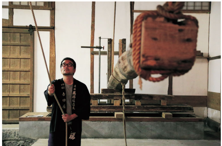
▲撥ね木をコントロールするのも手作業。ロープ一本で阿弥陀車を動かします
